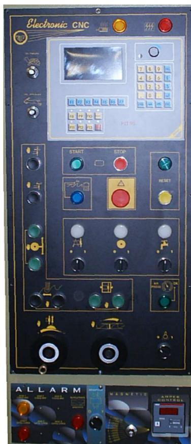
Sul pannello comandi, esterno e molto pratico per l'operatore, è installata una tastiera con monitor visualizzato che l'operatore può programmare secondo il tipo di lavorazione.
